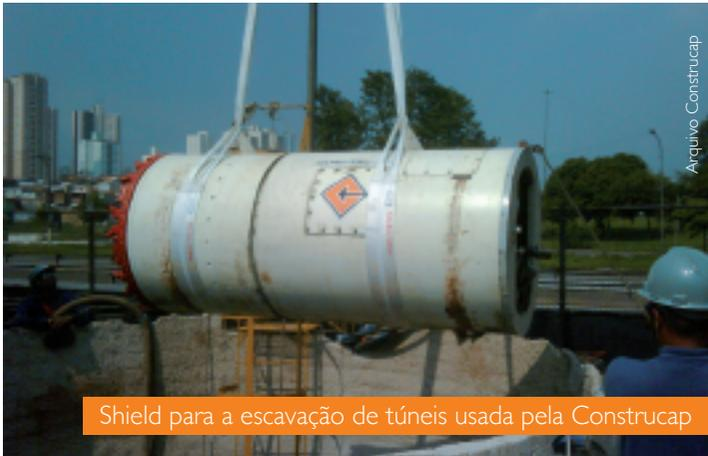
Shield para a escavação de túneis usada pela Construcap
